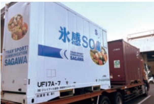
保管時は外部電源、輸送時は蓄電池により定温管理する「氷感SO庫」
