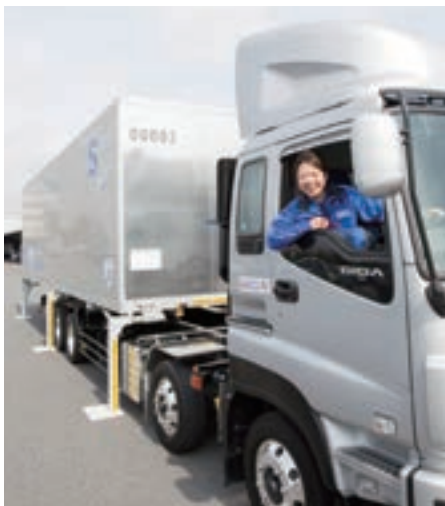
トラックの車体と荷台（コンテナ部）が完全分離できるスワップボディ車を増やしています。ドライバーが荷積み・荷降しに関わらず、運転に専念できるので、業務の効率化が期待できます。また、同車はトレーラーとは異なりけん引免許が必要ない「大型免許」で運転できることも問口を広げるポイントとなっています。
